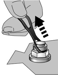
⇒ Das folgende Bild zeigt ein aktiviertes Entlüftungsventil:
