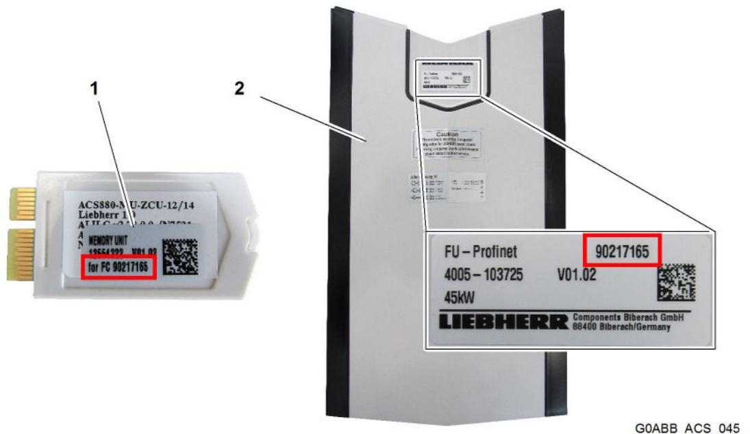
Fig. 51 Nummernvergleich der Memory Unit
