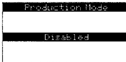
**Hinweis:** Sobald Deaktiviert mit der Eingabetaste bestätigt wurde, ist die Möglichkeit Aktiviert nicht mehr auf dem Bildschirm zu sehen und es ist daher nicht möglich, den Produktionsmodus über den HMI-Bildschirm zu aktivieren. Verwenden Sie IntelliConfig, um den Produktionsmodus zu aktivieren.
