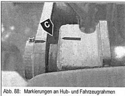
Abb. 88: Markierungen an Hub- und Fahrzeugrahmen
