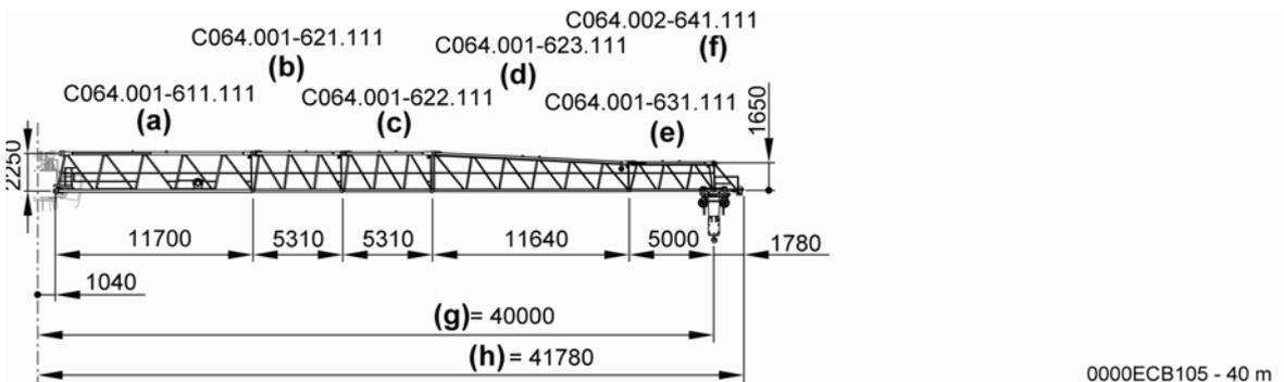
**Fig. 6-96** Anordnung Auslegerteile für 40 m Ausleger, 250 EC-B 12
