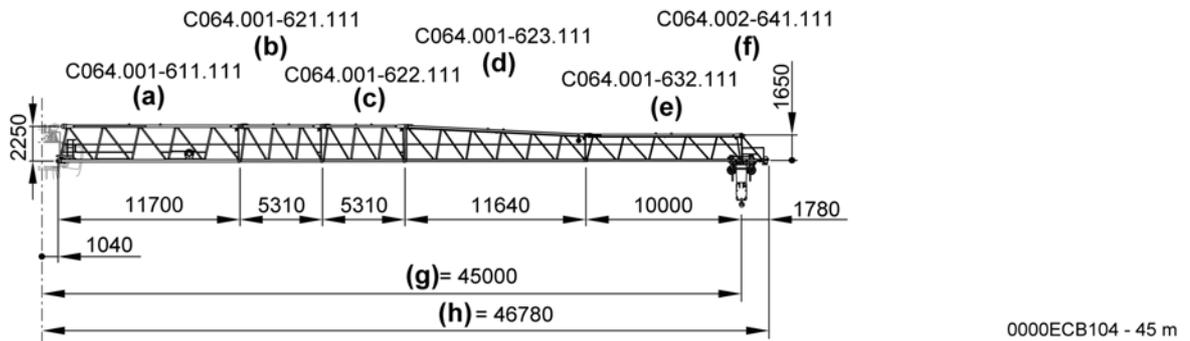
**Fig. 6-95** Anordnung Auslegerteile für 45 m Ausleger, 250 EC-B 12
