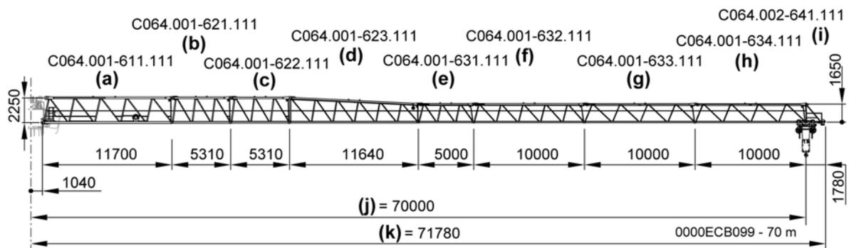
**Fig. 6-90** Anordnung Auslegerteile für 70 m Ausleger, 250 EC-B 12
