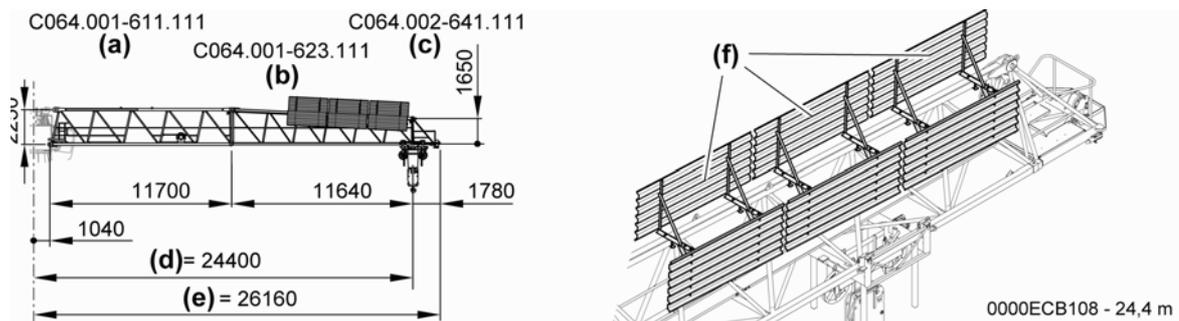
**Fig. 6-99** Anordnung Auslegerteile für 24,4 m Ausleger, 250 EC-B 12
