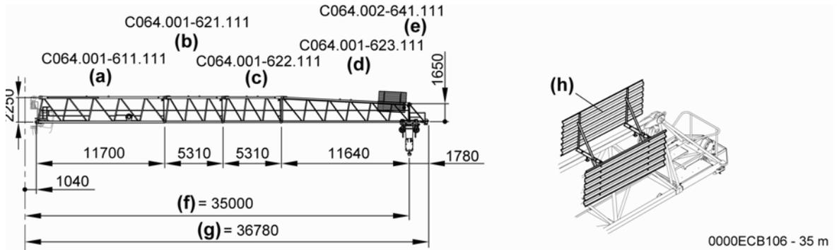
**Fig. 6-97** Anordnung Auslegerteile für 35 m Ausleger, 250 EC-B 12
