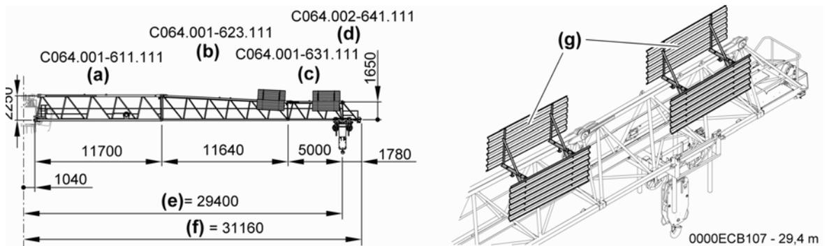
**Fig. 6-98** Anordnung Auslegerteile für 29,4 m Ausleger, 250 EC-B 12
