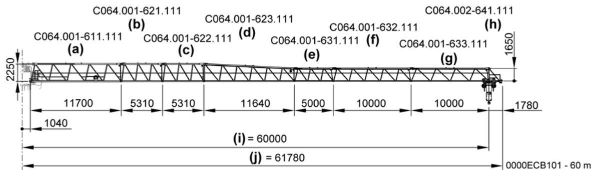
**Fig. 6-92** Anordnung Auslegerteile für 60 m Ausleger, 250 EC-B 12
