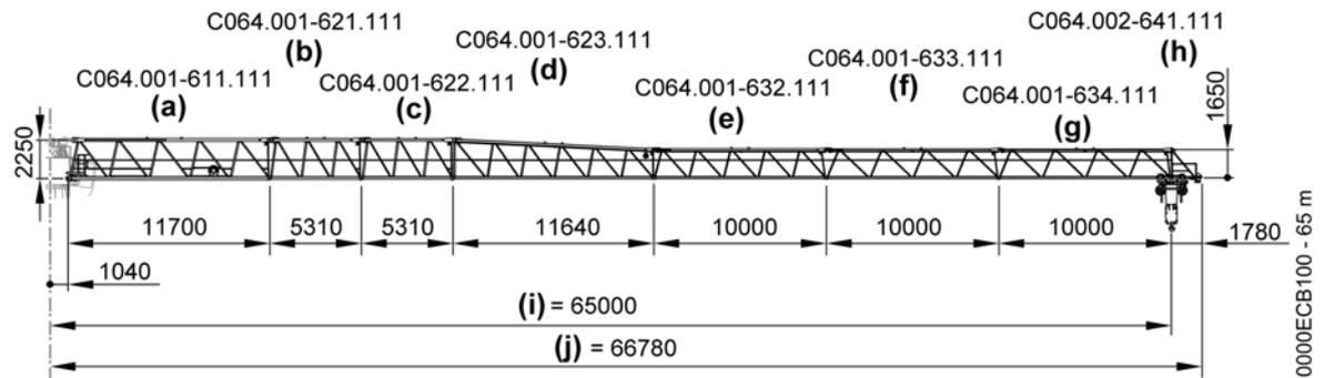
**Fig. 6-91** Anordnung Auslegerteile für 65 m Ausleger, 250 EC-B 12
