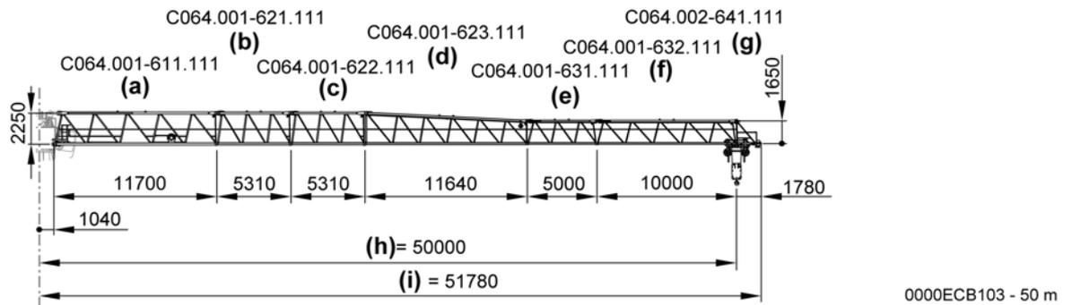
**Fig. 6-94** Anordnung Auslegerteile für 50 m Ausleger, 250 EC-B 12
