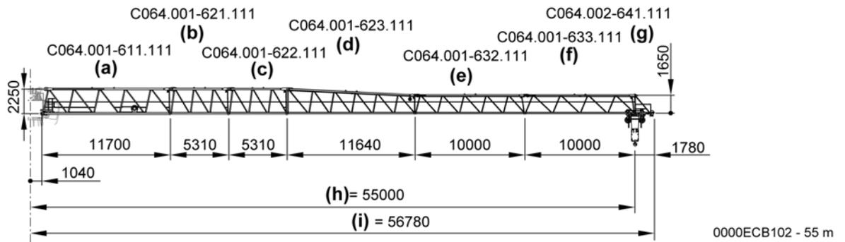
**Fig. 6-93** Anordnung Auslegerteile für 55 m Ausleger, 250 EC-B 12
