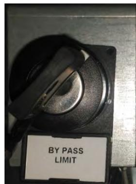
**HINWEIS:** Dieser Schalter dient zur Aktivierung der SAEZ-Option für Antikollisions- und Zonierungssysteme. Falls ein Fremdsystem im Kran installiert ist, muss dieser Schalter in der Sperrposition bleiben.
