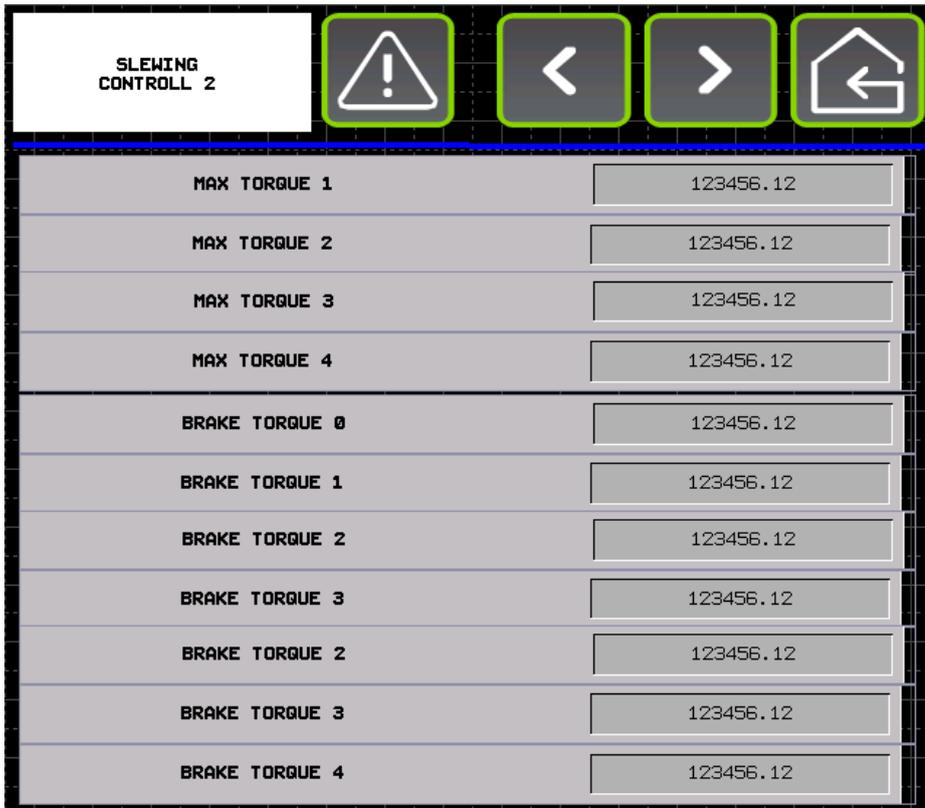
Auf der dritten Seite kann das Bremsenschließverhalten sowie das inkrementelle und dekrementelle Drehmoment konfiguriert werden:
