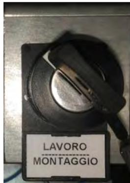
**WARNHINWEIS:** Der Montagemodus darf nur für die Montage und Demontage des Krans sowie für bestimmte Wartungsarbeiten verwendet werden. Es ist strengstens verboten, den Kran während der Durchführung regulärer Arbeiten in den Montagemodus zu versetzen.
