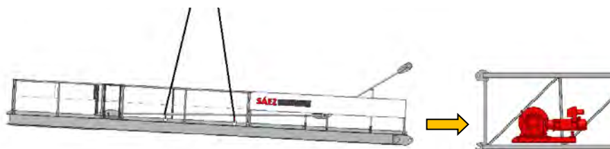
Annäherung des Gegenauslegers an das erste Auslegerstück
