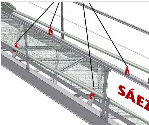
Detailansicht der Anschlagshaken zum Hochziehen des Gegenauslegers
