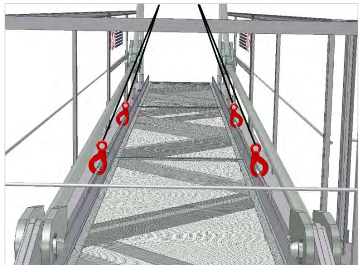
Detailansicht der Anschlagshaken zum Hochziehen des Gegenauslegers
