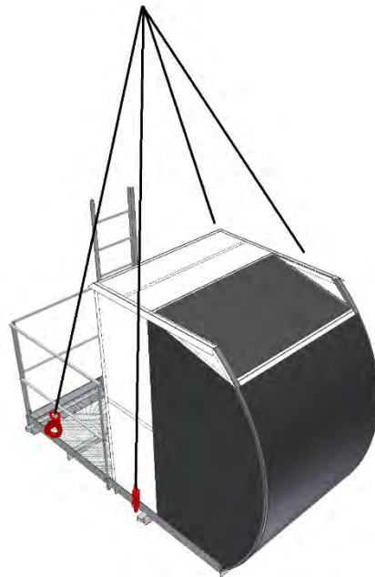
Abbildung 5. Hochziehen des Kabine Untergestell
