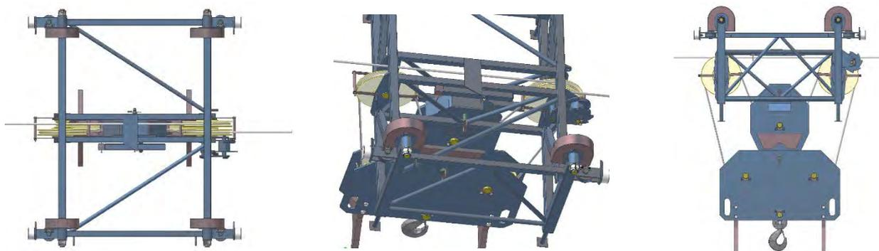
Das Ende des Hebeseils wird mit der rotierenden Verdrehsicherung durch einen Endkeil verbunden, die sich an der Auslegerspitze befindet.
