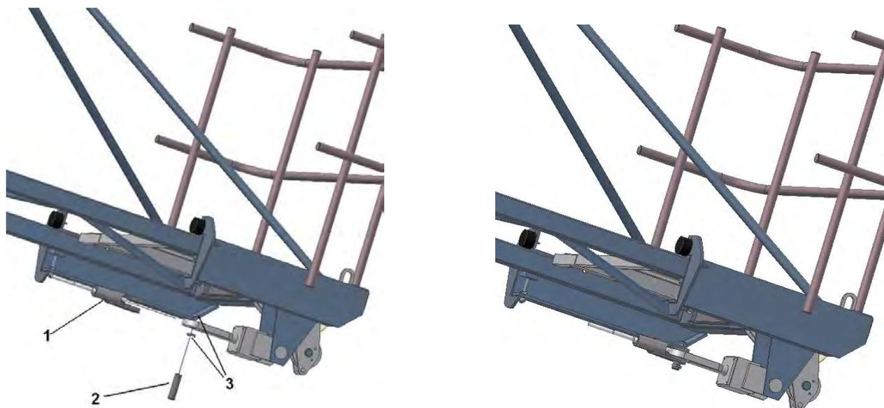
Der Einbau des Seils am Fixpunkt wird von der Plattform am Ende des Auslegers durchgeführt.
