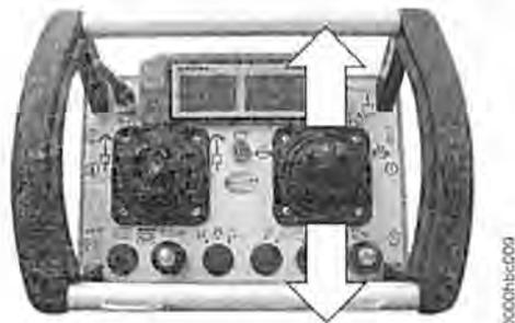
Fig. 465: Lasthaken heben und senken
