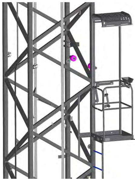
Steuerstand mit Schutzdach und Aufstiegsleiter
