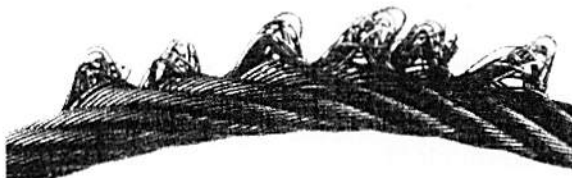
Bild 3 - Schlaufenbildung an einem Drahtseil
