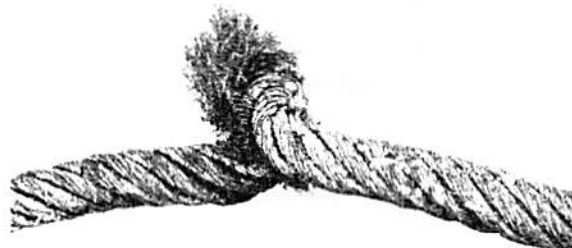
Bild 7 - Durch Zuziehen einer Seilschlinge entstandene Klanke
