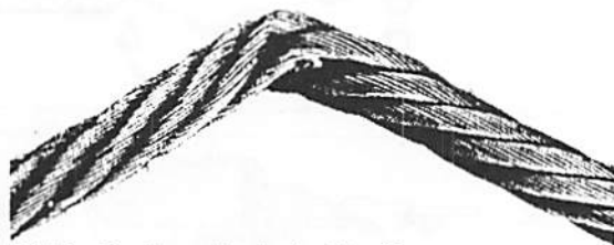
Bild 8 - Durch mechanische Einwirkung entstandener Knick
