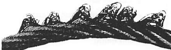
Bild 3 - Schlaufenbildung an einem Drahtseil
