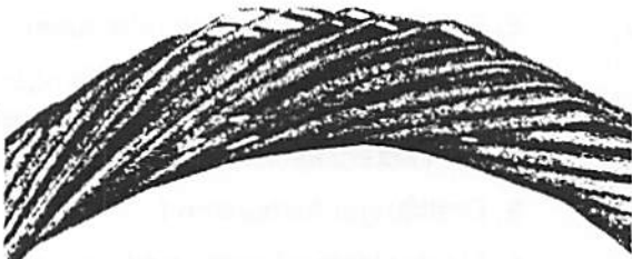
Bild 4 - Durch Korrosion und Abrieb stark gelockerte Litze
