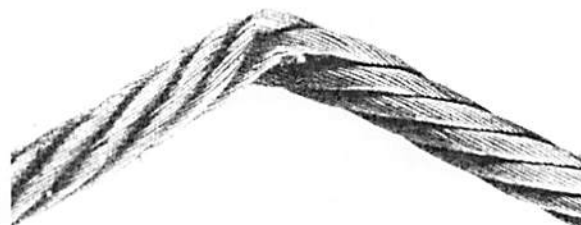
Bild 8 - Durch mechanische Einwirkung entstandener Knick
