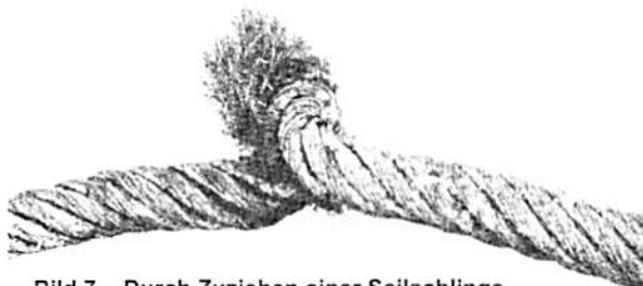
Bild 7 - Durch Zuziehen einer Seilschlinge entstandene Klanke
