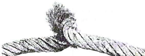
Bild 7 - Durch Zuziehen einer Seilschlinge entstandene Klanke
