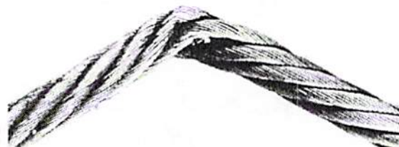
Bild 8 - Durch mechanische Einwirkung entstandener Knick
