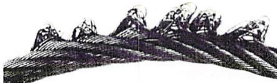
Bild 3 - Schlaufenbildung an einem Drahtseil
