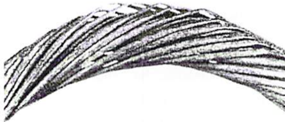
Bild 4 - Durch Korrosion und Abrieb stark gelockerte Litze
