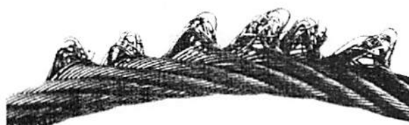
Fig. 3 - Formation de boucles sur un câble d'acier
