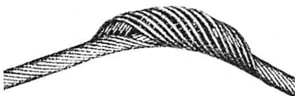
Fig. 2 - Déformation en forme de «panier»
