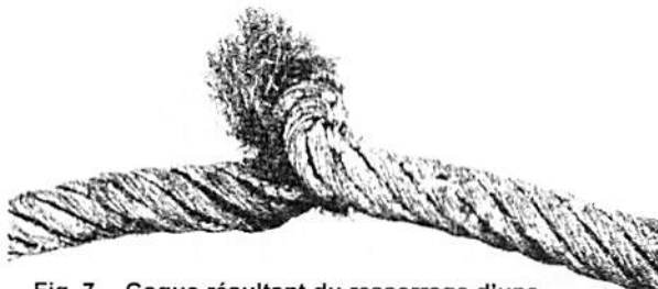
Fig. 7 - Coque résultant du resserrage d'une boucle de câble
