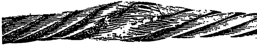
Bild 7. Drahtseil mit Abplattung, entstanden durch Überfahren
