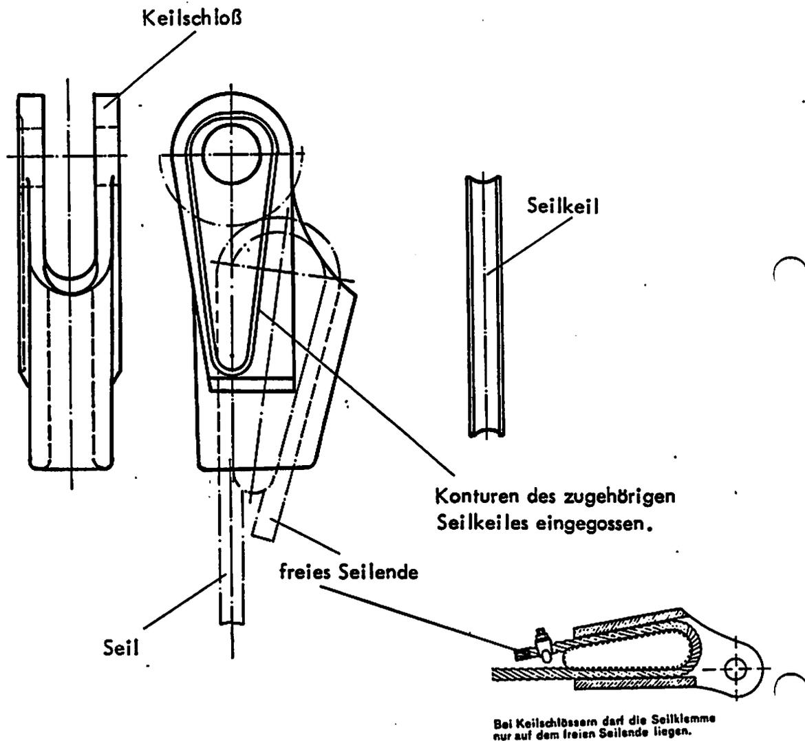
Mit dem Keilschloß können Drahtseile an feste Konstruktionsteile angeschlossen werden. Unter Belastung zieht sich das um den Keil geführte Seil in die Tasche des Keilschlusses hinein und ergibt eine feste Verbindung. Bei dieser Verbindung ist ein einfaches Lösen des Seiles durch Herausschlagen des Keiles möglich.
