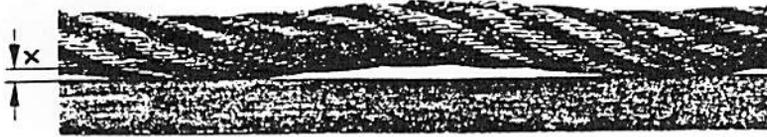
Bild 1. Drahtseil mit kornenzieherartiger Verformung
