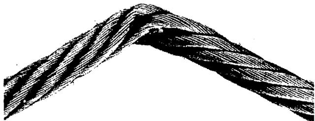
Bild 16 - Durch mechanische Einwirkung entstandener Knick
