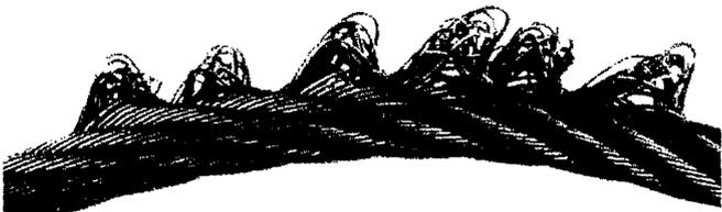
Bild 11 - Schlaufenbildung an einem Drahtseil
