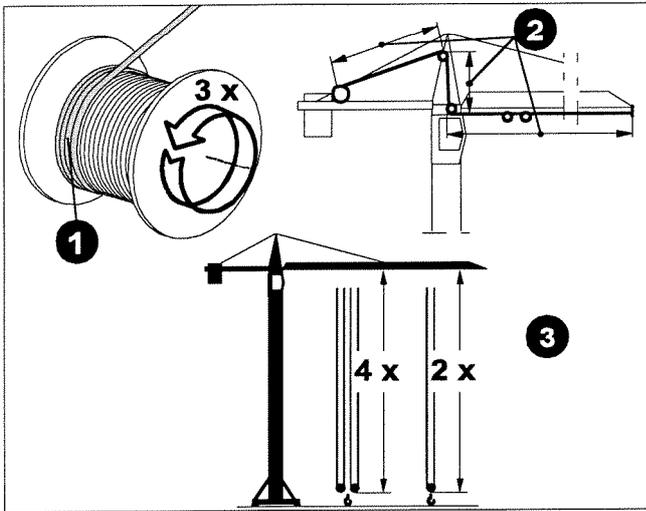
**Auf die Kranaufbauhöhe optimal angepasste Seillänge !**
