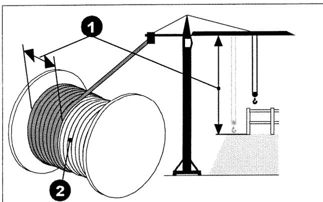
**Die unteren Seillagen werden nicht benutzt (Totwindungen), Hubseil abspulen und unter Vorspannung (ca. 10% der max. Last) neu aufspulen !**
