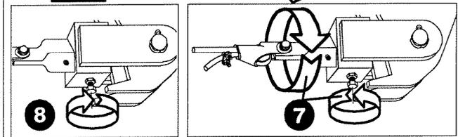
9. Mit der Hakenflasche und der Laufkatze einige Leerfahrten durchführen. Dadurch wird die Drehung auf die gesamte Seillänge verteilt.
