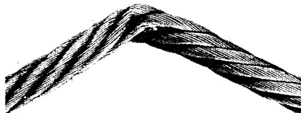
Bild 8 - Durch mechanische Einwirkung entstandener Knick
