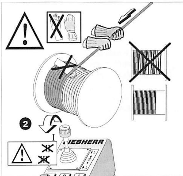
2. Hubseil in Stufe 1 aufspulen und führen.
