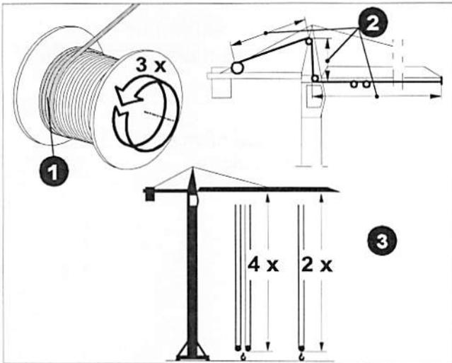
**Auf die Kranaufbauhöhe optimal angepasste Seillänge !**
