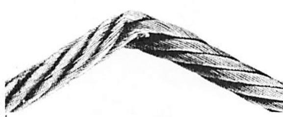
Bild 8 - Durch mechanische Einwirkung entstandener Knick
