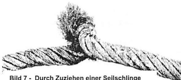
Bild 7 - Durch Zuziehen einer Seilschlinge entstandene Klanke
