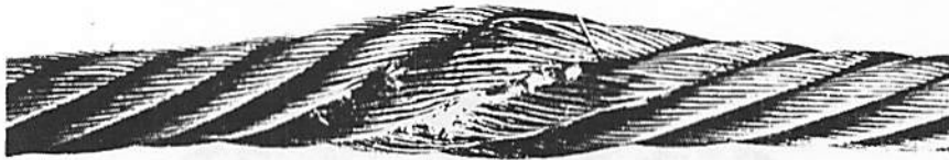
Bild 7. Drahtseil mit Abplattung, entstanden durch Überfahren
