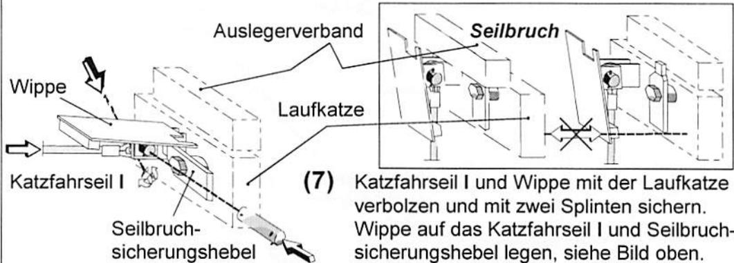
(7) Katzfahrseil I und Wippe mit der Laufkatze verbolzen und mit zwei Splinten sichern. Wippe auf das Katzfahrseil I und Seilbruchsicherungshebel legen, siehe Bild oben.
