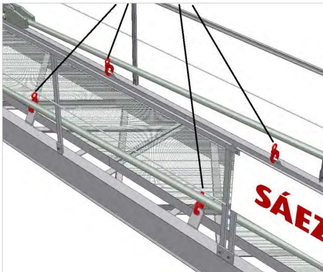
Detailansicht der Anschlagshaken zum Hochziehen des Gegenauslegers
