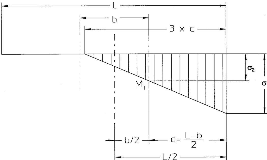
$$\text{max. } M_i = \sigma_2 \cdot \frac{d^2}{2} + (\sigma_1 - \sigma_2) \cdot \frac{d^2}{3} - h_F \cdot 25 \cdot \frac{d^2}{2}; \text{ mit } d = \frac{L-b}{2} = 2,16 \text{ m}$$
