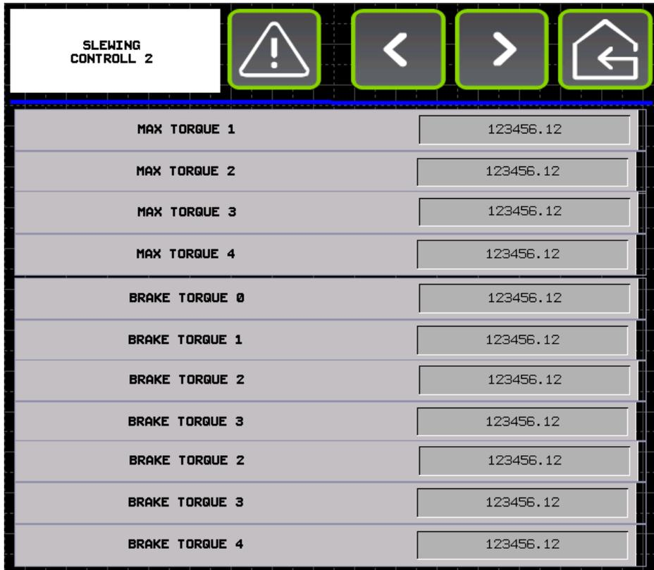
Auf der dritten Seite können das Bremsschließverhalten sowie das inkrementale und dekrementale Drehmoment konfiguriert werden:
