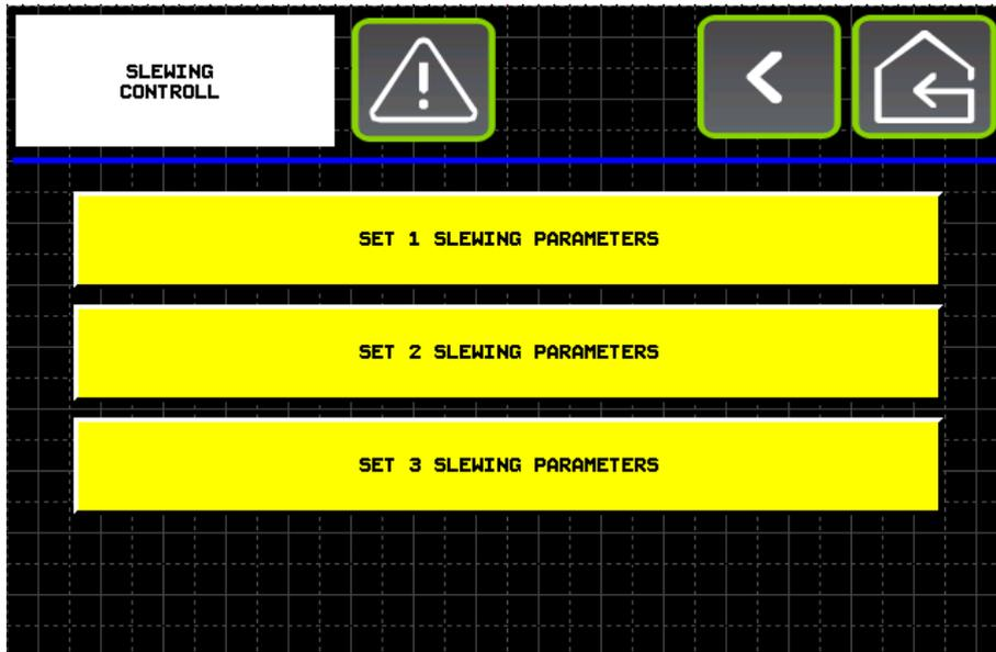
Die Konfiguration der drei verschiedenen Schwenkmodi, die auf dem Hauptbildschirm ausgewählt werden können, werden durch Drücken auf diese konfiguriert.
