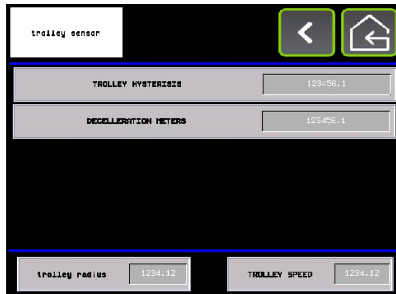
In diesem Bildschirm kann die Laufkatzbegrenzungshysterese konfiguriert werden. Als Hysterese wird die Anzahl der Meter definiert, die die Laufkatze zurücklegen muss, um den innenliegenden und außenliegenden Anschlag der Laufkatze zu lösen, damit sie wieder eingestellt werden können.
