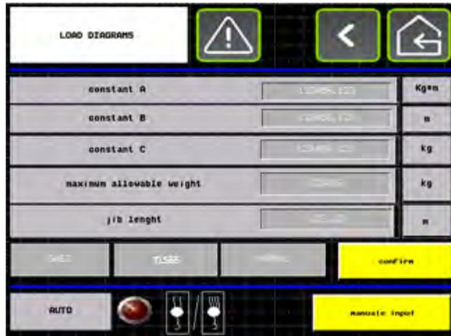
An der Stelle, an der **TLS65** (oder ein anderes Kranmodell) steht, kann das gewünschte Kranmodell durch ein Dropdown Menü gewählt werden. Der **Bestätigungs**-Taster muss gedrückt werden, sobald das gewünschte Modell ausgewählt wurde.
