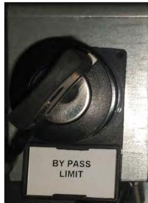
**HINWEIS:** Dieser Schalter ist zum Einschalten der SAEZ Option für Antikollisions- und Begrenzungssysteme, wenn ein fremdes System im Kran installiert ist muss sich dieser Schalter in der „Aus“ Position befinden.
