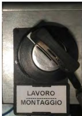
**WARNUNG:** Der Aufstellmodus ist nur zum Auf- und Abbau des Krans sowie für bestimmte Wartungsarbeiten vorgesehen. Es ist strikt untersagt, den Kran bei der Durchführung regulärer Arbeiten in den Aufstellmodus zu setzen.
