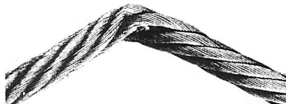
Bild 8 - Durch mechanische Einwirkung entstandener Knick
