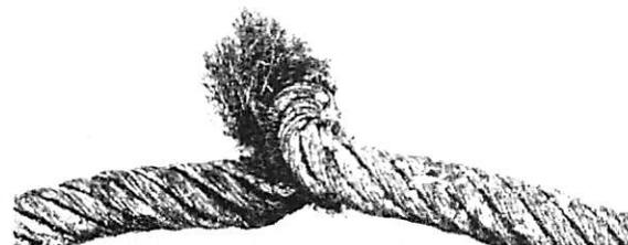
Bild 7 - Durch Zuziehen einer Seilschlinge entstandene Klanke
