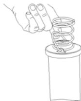
2. Filterelement langsam am Bügel herausziehen und Öl in den Tank laufen lassen.
