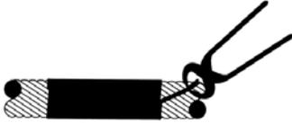
Dann wird das überwickelte Drahtstück mit Hilfe einer Zange strammgezogen und gemeinsam mit dem zweiten Drahtende verdreht.
