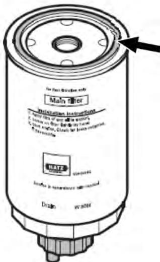
5. Dichtung des neuen Kraftstofffilters leicht einölen.
