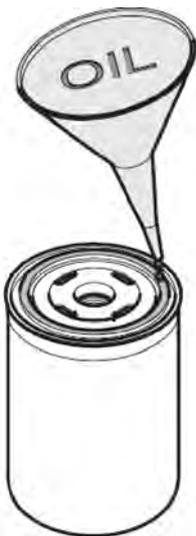
3. Dichtlippe des neuen Ölfilters leicht einölen.
