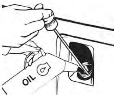
6. Ist der Ölstand in der Nähe der min.-Markierung, Motoröl bis zur max.-Markierung nachfüllen.
