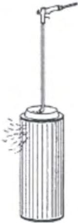
2. Hauptelement mit trockener Druckluft (maximal 5 bar / 72.5 psi) vorsichtig durch Auf- und Abbewegen des Rohres im Hauptelement so lange von innen nach außen ausblasen, bis keine Staubentwicklung mehr auftritt.
