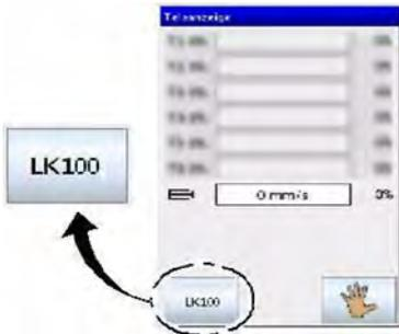
1. Schmierlänge (im Beispiel LK 100) durch Drücken auf den Längencode auswählen. Die angewählte Zeile wird farbig hinterlegt.
