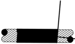
Das Seil wird nun auf einer Länge von etwa 3 mal dem Seildurchmesser stramm umwickelt.
