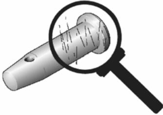
1. Alle Bolzen regelmäßig, z. B. bei Montage- oder Demontearbeiten, auf Risse prüfen.
