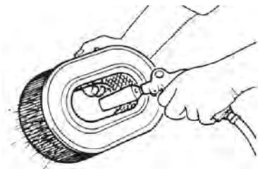
2. Filterpatrone mit trockener Druckluft so lange von innen nach außen ausblasen, bis kein Staub mehr austritt.
