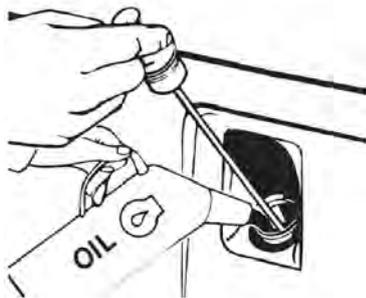
3. Motoröl über Öleinfüllöffnung auffüllen.
