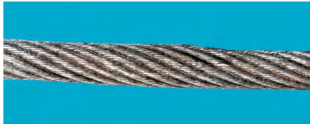
**Abbildung 307:** Lokale Seildurchmessererhöhung durch Verformung der Einlage
