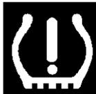
2. Reifendruck korrigieren, sobald die Kontrollleuchte im Fahrerinformationssystem in der Fahrerkabine aufleuchtet.
