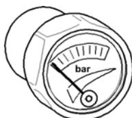
3. Reifendruck korrigieren, sobald der angezeigte Reifendruck unter den erforderlichen Reifendruck fällt (siehe Tabelle).
