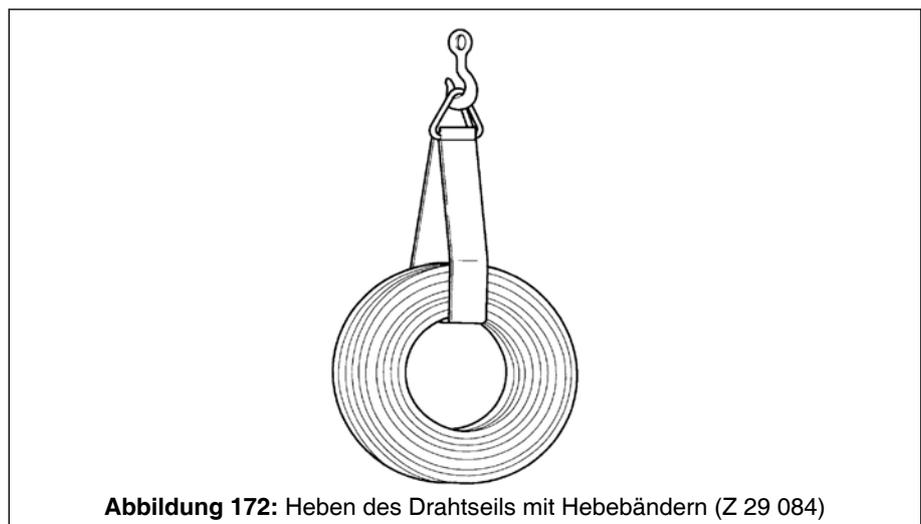
Abbildung 172: Heben des Drahtseils mit Hebebändern (Z 29 084)
