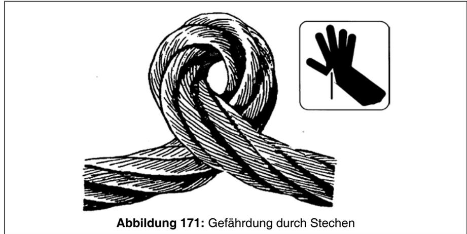
Abbildung 171: Gefährdung durch Stechen
