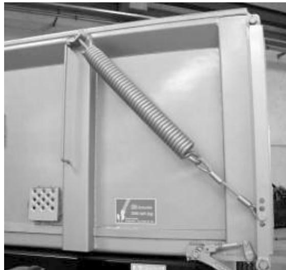
Bei Kippen ohne Bordwandhebefedern darf der obere Verriegelungshebel der Pendelbordwand weder im leeren noch im beladenen Zustand des Kipp-Anhängers geöffnet werden, solange die Bordwand nicht mittels Kran oder ähnlicher Hebeeinrichtung von oben gehalten wird (Lebensgefahr!).
