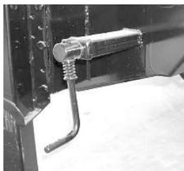
Feststellbremse funktioniert über Seilzug und muss in sinnvollen abständen auf Funktionsfähigkeit geprüft werden. Anzugskraft der manuellen Feststellbremsspindel muss ca. 40 kg Handkraft betragen.
