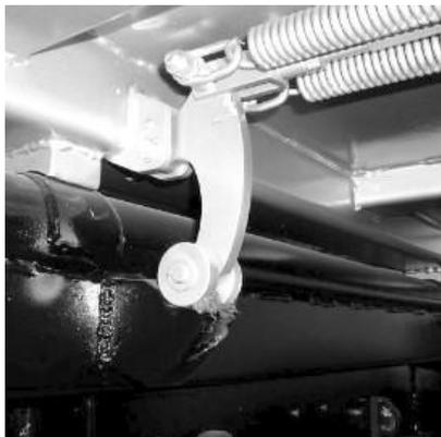
Bei Kipper mit automatischer Öffnungseinrichtung entriegelt und verriegelt die hintere Bordwand beim Kippen automatisch. Bei diesen Fahrzeugen ist darauf zu achten, dass sich beim Kippen im hinteren Kippbereich keinesfalls Personen aufhalten.
