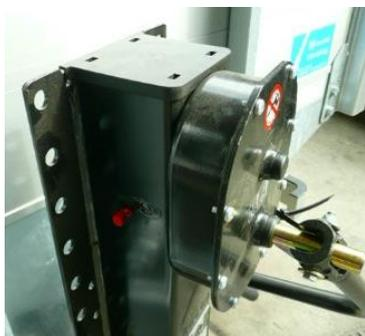
**Die Stützvorrichtung soll nach bedarf, mindestens jedoch halbjährlich, an den vorhandenen Schmiernippel mit Fett abgeschmiert werden. Dabei Stützvorrichtung über den gesamten Hub bis zum Endanschlag aus- und wieder einkurbeln, um die beweglichen Teile ausreichend zu schmieren.**
