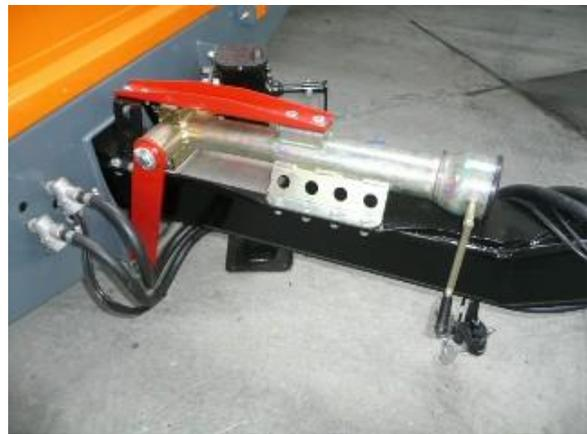
**Das Zugrohr kann durch Drehen der Kurbeln in der Höhe verstellt werden, und so dem Zugfahrzeug angepasst werden.**
