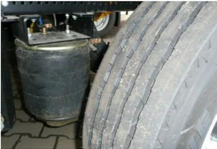
**Grundsätzlich vor jeder Fahrt zu den oben zutreffenden Wartungsarbeiten die Luftfederbeläge auf Risse, Undichtigkeiten, Umstülpungen und Gummiversprödung hin zu überprüfen. Bei defekten Bälgen darf die Fahrt nicht aufgenommen werden.**
