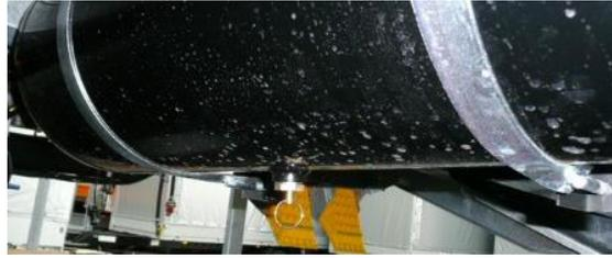
**Der Luftbehälter der Bremsanlage muß durch Betätigen des Entwässerungsventils täglich entwässert werden. Bei Verschmutzung ist das Entwässerungsventil herauszuschrauben und zu reinigen. Der Druckluftbehälter darf nicht beschädigt sein und keine äußeren Korrosionsschäden aufweisen.**
