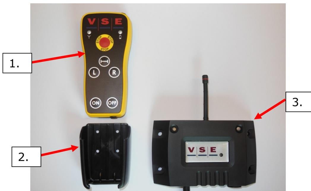
Il est recommandé de monter le logement (2) en un endroit facilement accessible (par exemple dans la cabine du tracteur) et, lorsqu'il n'est pas utilisé, de ranger l'émetteur manuel dans le logement.
