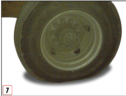
7 Tyre deformation because of excessive loading Reifenverformung durch Überlast
