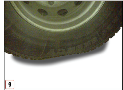
9 Tyre deformation because of excessive loading. Tractor tyre. Reifenverformung durch Überlast. Zugfahrzeug.
