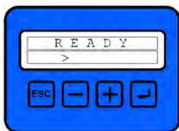
Im fehlerfreien Zustand wird in der ersten Zeile "READY" angezeigt. In der zweiten Zeile bewegt sich ein ">"-Zeichen von links nach rechts. Diese Anzeige signalisiert, dass der Lenkcomputer aktiv ist.
