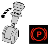
2. Hebel der Feststellbremse aus der Lösestellung bis zur Vollbremsstellung schwenken und einrasten.
