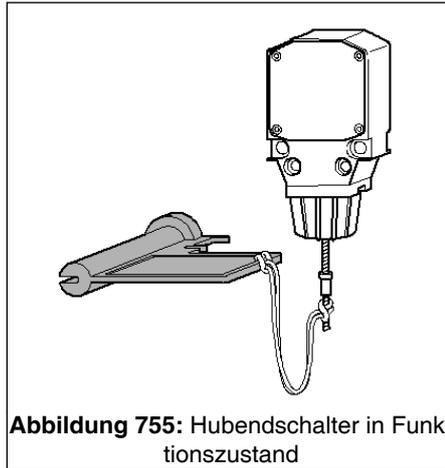
Abbildung 755: Hubenschalter in Funktionszustand
