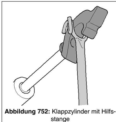
Abbildung 752: Klappzylinder mit Hilfsstange
