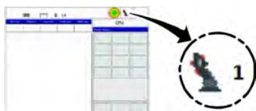
1. Der Arbeitsaufgabe entsprechenden Modus für die Belegung der Steuerhebel anwählen. Der aktuelle Modus (hier: 1) wird in der obersten Zeile der Maske "Kranbetrieb" angezeigt.
