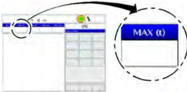
Die von der Kransteuerung in unverbolztem Zustand zugelassenen Tragfähigkeitswerte "MAX (t)" können gehoben werden.
