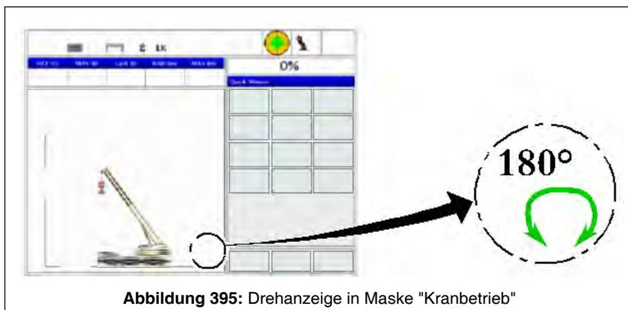
Abbildung 395: Drehanzeige in Maske "Kranbetrieb"
