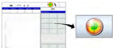
Betätigen Sie im Quick Menü die dargestellte Taste, um die Maske "Tragfähigkeitsradar" aufzurufen.
