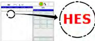
Wie beschrieben wird bei angefahrenen und nicht überbrückten Hubendschaltern der Schriftzug "HES" an der Maske "Kranbetrieb" rot dargestellt eingeblendet.
