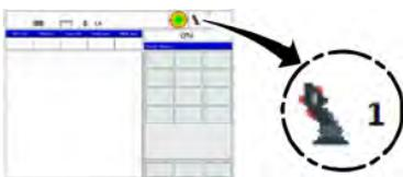
1. Der Arbeitsaufgabe entsprechender Modus für die Belegung der Steuerhebel anwählen. Der aktuelle Modus (hier: 1) wird in der obersten Zeile der Maske "Kranbetrieb" angezeigt.
