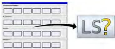
Betätigen Sie im Hauptmenü bei den Diagnose-Einstellungen die dargestellte Taste, um die Maske "Load-Sensing-Anzeige" zur Diagnose des Systems aufzurufen.
