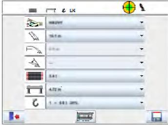
Beim Aufrufen der Maske "Anwahl der Betriebsart" wird die gemessene Stützbasis angezeigt. Falls die zuletzt gemachten Einstellungen von den jetzt gemessenen Werten abweichen, wird der Ausfahrzustand in roter Schrift dargestellt. Die Auswahl ist entweder zu bestätigen oder durch Änderung der Konfiguration anzupassen.
