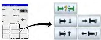
⇒ Die Funktionstasten zur Bedienung der Sicherungs- und Verbolzungseinheit (SVE) sind nicht mehr ausgegraut dargestellt. Die Kransteuerung befindet sich jetzt im manuellen Teleskopierbetrieb.
