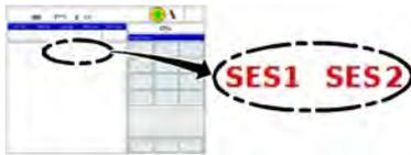
Ist ein Senkendschalter angefahren, so erscheint in der Maske "Kranbetrieb" der Schriftzug "SES1" bzw. "SES2" in rot. Der Warnsummer ertönt. "Hubwerk senken" wird abgeschaltet. Nur "Hubwerk heben" ist möglich.
