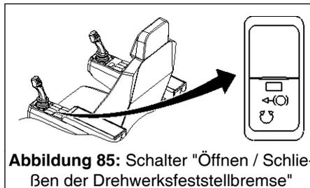
Abbildung 85: Schalter "Öffnen / Schließen der Drehwerksfeststellbremse"
