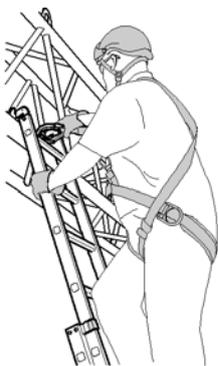
Nebenstehendes Bild zeigt die Leiter korrekt an einem Leiterhalter eingehängt und Personal zusätzlich mit persönlicher Schutzausrüstung ausgestattet und gesichert.
