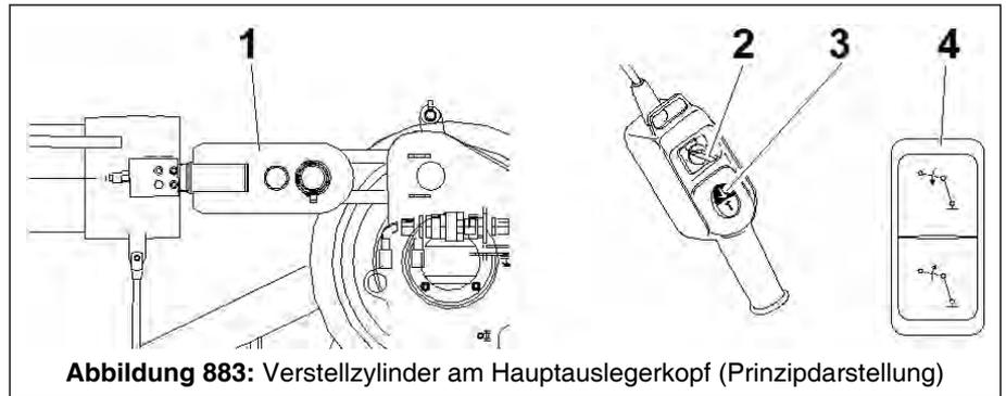
**Abbildung 883:** Verstellzylinder am Hauptauslegerkopf (Prinzipdarstellung)
