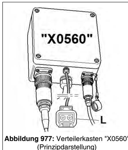
Abbildung 977: Verteilerkasten "X0560" (Prinzipdarstellung)
