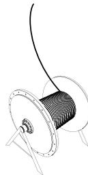
> Die Seiltrommel ist so aufgebockt, dass sie sich beim Abwickeln des Seils frei drehen kann (C).
