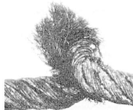
Drahtseil mit Klanke (entstanden durch Zuziehen einer Schlinge)
