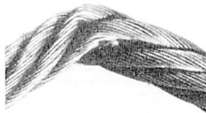
Drahtseil mit Klanke (entstanden durch Zuziehen einer Schlinge)
