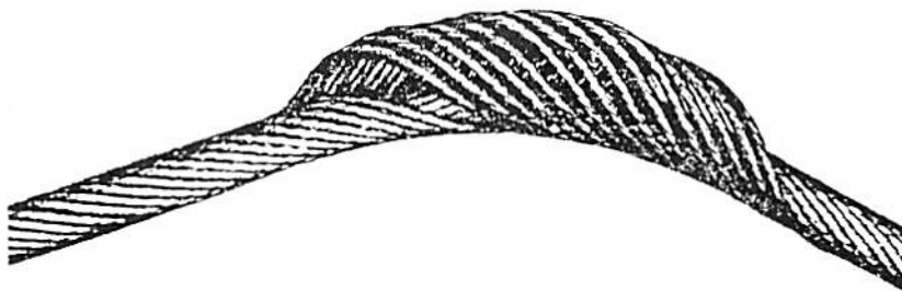
Bild 2. Drahtseil mit Korbbildung
