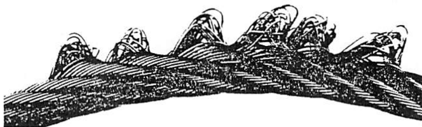
Bild 3. Drahtseil mit Schlaufenbildung von Drähten
