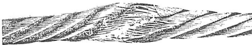
Bild 7. Drahtseil mit Abplattung, entstanden durch Überfahren
