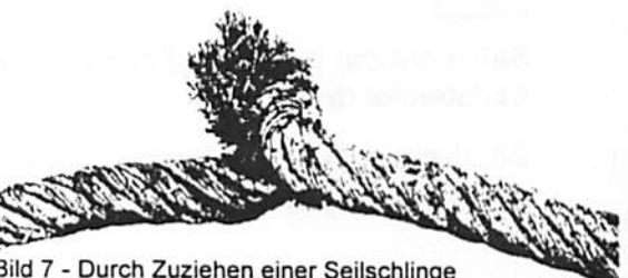
Bild 7 - Durch Zuziehen einer Seilschlinge entstandene Klenke
