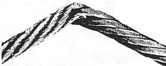
Bild 8 - Durch mechanische Einwirkung entstandener Knick
