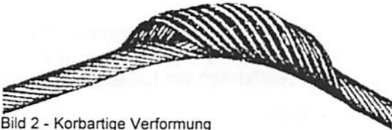
Bild 2 - Korbartige Verformung
