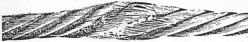
Bild 7. Drahtseil mit Abplattung, entstanden durch Überfahren
