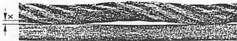
Bild 1. Drahtseil mit korkenzieherartiger Verformung
