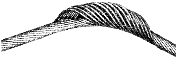
Fig. 2 - Déformation en forme de «panier»
