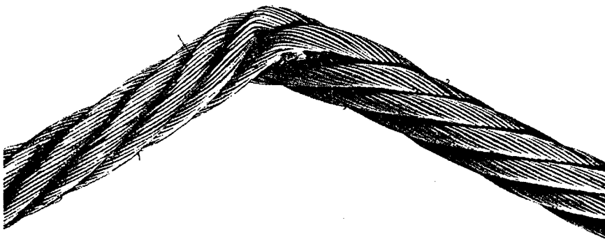
Bild 9. Drahtseil mit Knick
