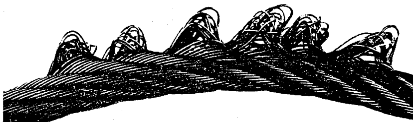
Bild 3. Drahtseil mit Schlaufenbildung von Drähten
