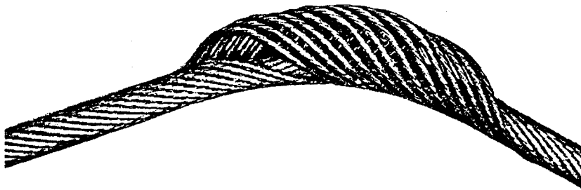
Bild 2. Drahtseil mit Korbbildung
