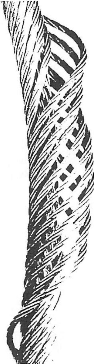
Abb. 1 - Spiralverdrehung: Eine Deformation, bei der die Längsachse des Seils die Form einer Spirale annimmt.
