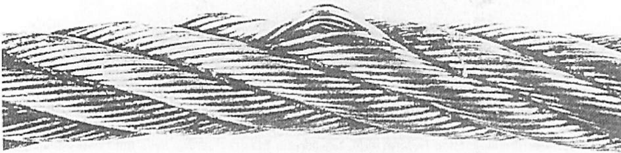
Abb. 4 - Ein Kardeel, das nur vom Auswurf von Litzen betroffen ist, wenn auch die Kontrolle auf einem Seilstück zeigt, dass die Deformation in regelmäßigen Abständen sichtbar ist, die normalerweise der Länge einer Umwicklung entspricht.
