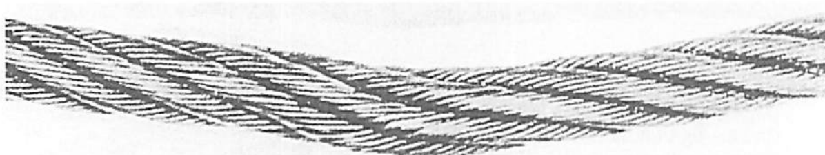
Abb. 11 - Seil, das während der Aufstellung verwickelt wurde, das aber in Betrieb genommen wurde und nun einen örtlich begrenzten Verschleiß aufweist. Bedingung, die den sofortigen Austausch erfordert.
