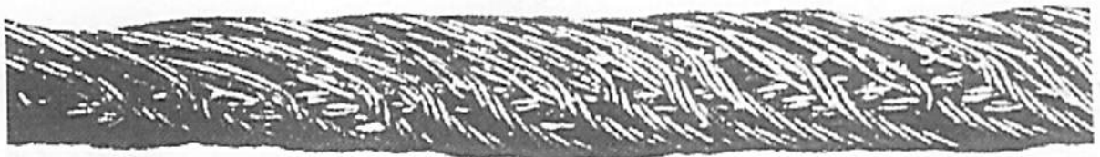
Abb. 9 - Abgeflachtes Teilstück eines Seiles mit vielen Kardeelen, das von der unrichtigen Abwicklung der Trommel verursacht wurde. Zu berücksichtigen ist die größere Aufwicklungslänge der äußeren Schicht der Kardeele. Es wird auch ein Spannungsungleichgewicht bei der Ladebedingung geben. Bedingung, die den sofortigen Austausch erfordert.
