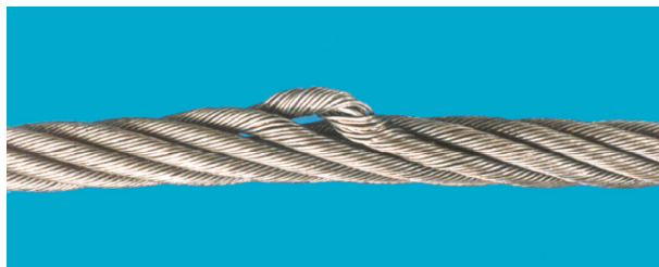
Abbildung 219: Heraustretende oder verformte Litze
