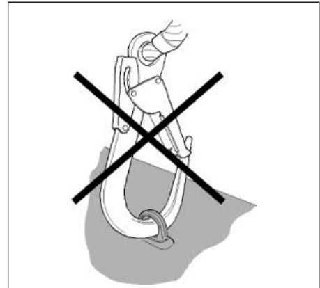
Abbildung 524: Haken mit falscher Größe
