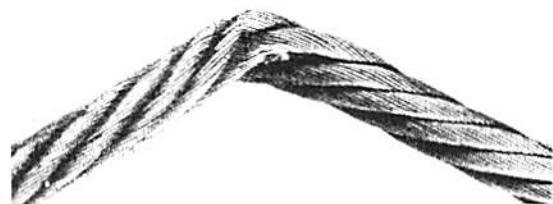
Bild 8 - Durch mechanische Einwirkung entstandener Knick
