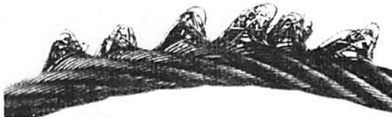
Bild 3 - Schlaufenbildung an einem Drahtseil
