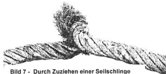
Bild 7 - Durch Zuziehen einer Seilschlinge entstandene Klanke
