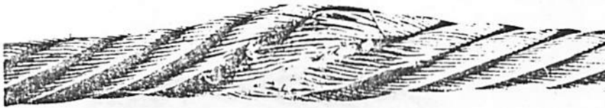
Bild 7. Drahtseil mit Abplattung, entstanden durch Überfahren
