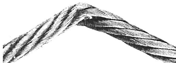
Bild 8 - Durch mechanische Einwirkung entstandener Knick
