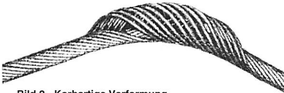
Bild 2 - Korbartige Verformung
