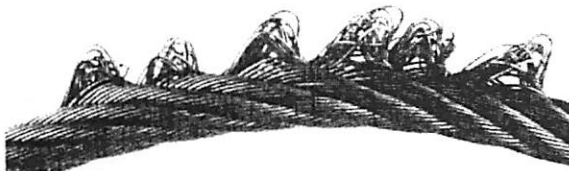
Bild 3 - Schlaufenbildung an einem Drahtseil
