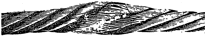
Bild 7. Drahtseil mit Abplattung, entstanden durch Überfahren
