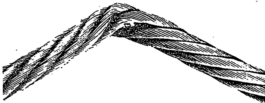
Bild 9. Drahtseil mit Knick
