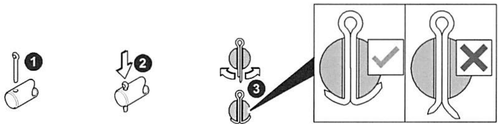
Fig. 46: Splint einsetzen
